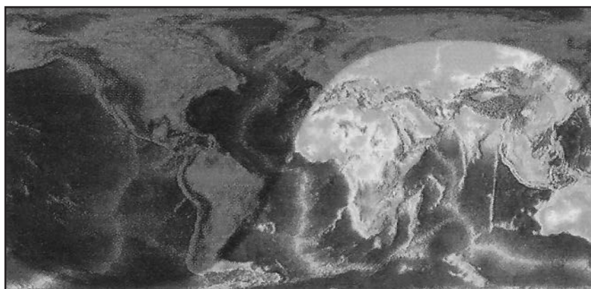
Figura 4: Línea gris durante el solsticio de invierno. La diferencia entre las líneas grises de ambos solsticios permite recorrer un sector terrestre de 46° a lo largo de todo el año.
