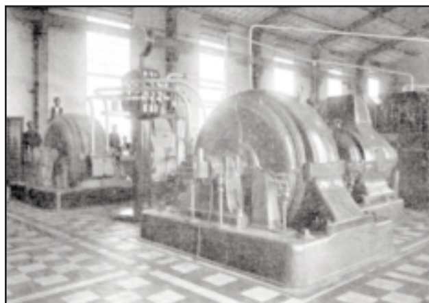
Alternadores Alexanderson de 400 kW y 500 kW
