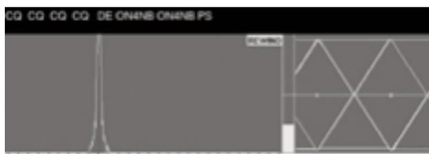
*Abajo, ninguna señal en la frecuencia; el diagrama sólo muestra ruido.*
