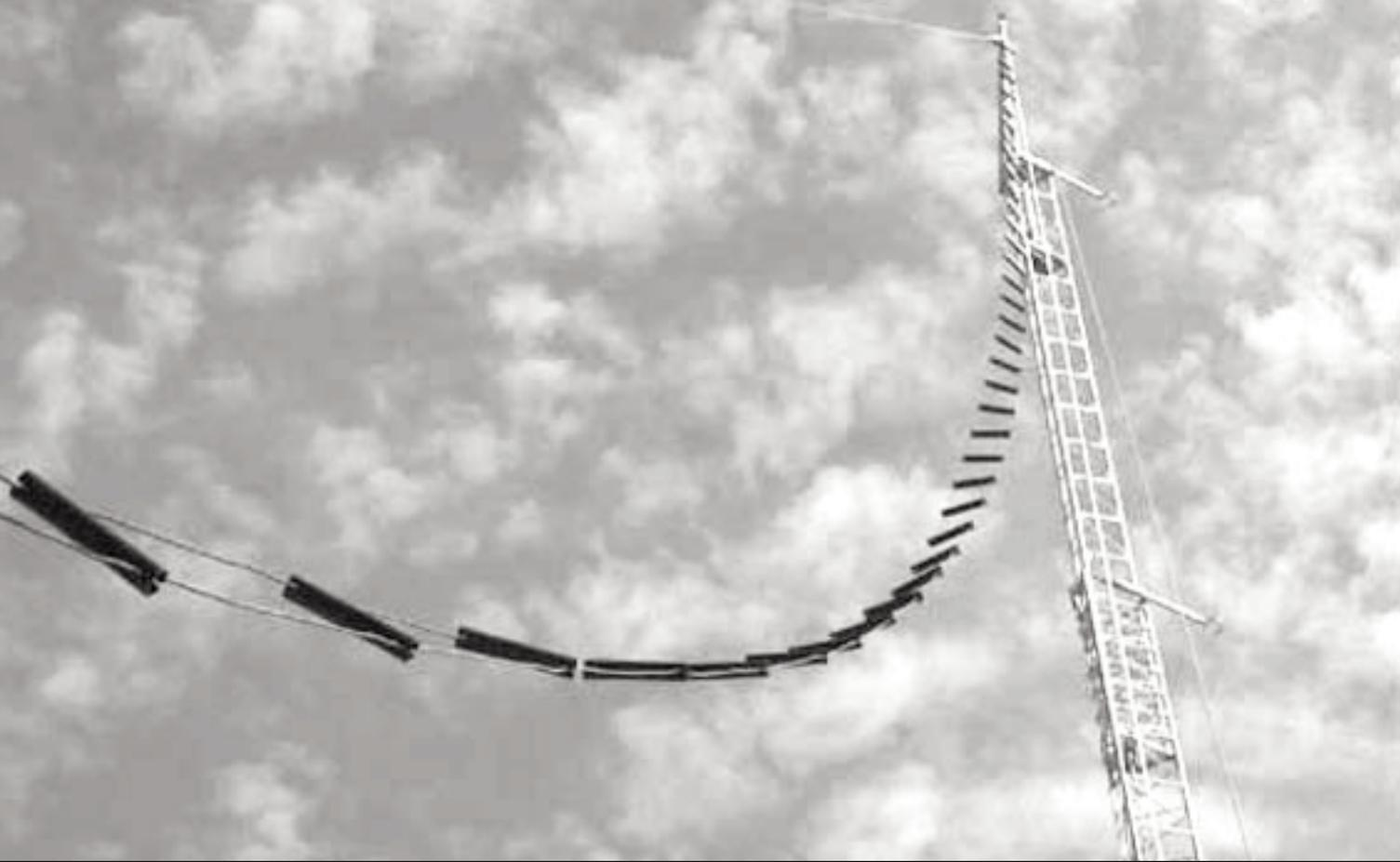
una, versión Louis Varney de 15,5 m de largo, instalada "a 3 metros del suelo", alimentada "con una cinta de  $300 \Omega$  de 4,5 m conectada a 15 m de RG8X" y que la "opera de 30 a 6 metros".
