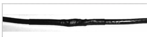
Fig. 13: Ubicar la última pieza de termocontraíble completa el proceso, restituyendo el cable coaxial cortado a su apariencia y propiedades eléctricas casi originales.
