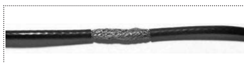
Fig. 12: Una vez realizado el procedimiento, las dos trenzas restituyen la malla exterior del cable coaxial en el punto de empalme.
