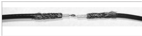
Fig. 9: Después de entrelazar los bucles centrales del conductor, apriételos suavemente y suéldelos.
