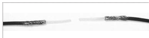
Fig. 6: Con el conductor central y la malla preparados en cada extremo del coaxial, está todo listo para comenzar el proceso de empalme.
