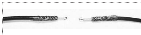
Fig. 8: Corte cuidadosamente el aislamiento del conductor central, teniendo cuidado de no cortar el conductor interno y haga un pequeño bucle en cada extremo.
