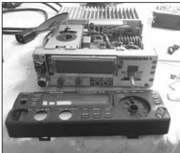
TS-50 desarmado para su limpieza y puesta a punto.
