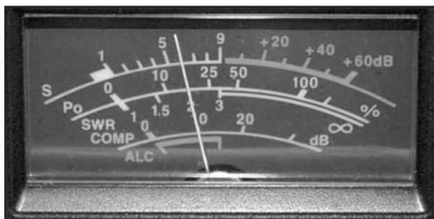
Instrumento de un IC-746 con el indicador del rango de ALC abajo a la izquierda. Algunos se refieren a ella como la "zona segura" del ALC.
