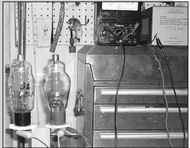
Figura 1. Un primer plano del soporte de la lámpara. Durante el proceso de rejuvenecimiento, deben mantenerse en posición vertical y no estar sometidas a ninguna vibración durante el proceso de calentamiento.
