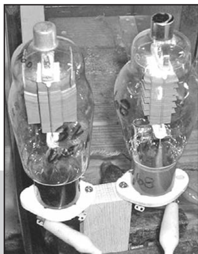
Figura 2. Lámparas viejas como estas 811 pueden ser rejuvenecidas utilizando este sencillo método. En las 811 de la derecha se está aumentando su nivel de emisión. La de la izquierda está actuando como balasto para el filamento, suministrando el voltaje desde la fuente de alimentación en la parte superior derecha.
