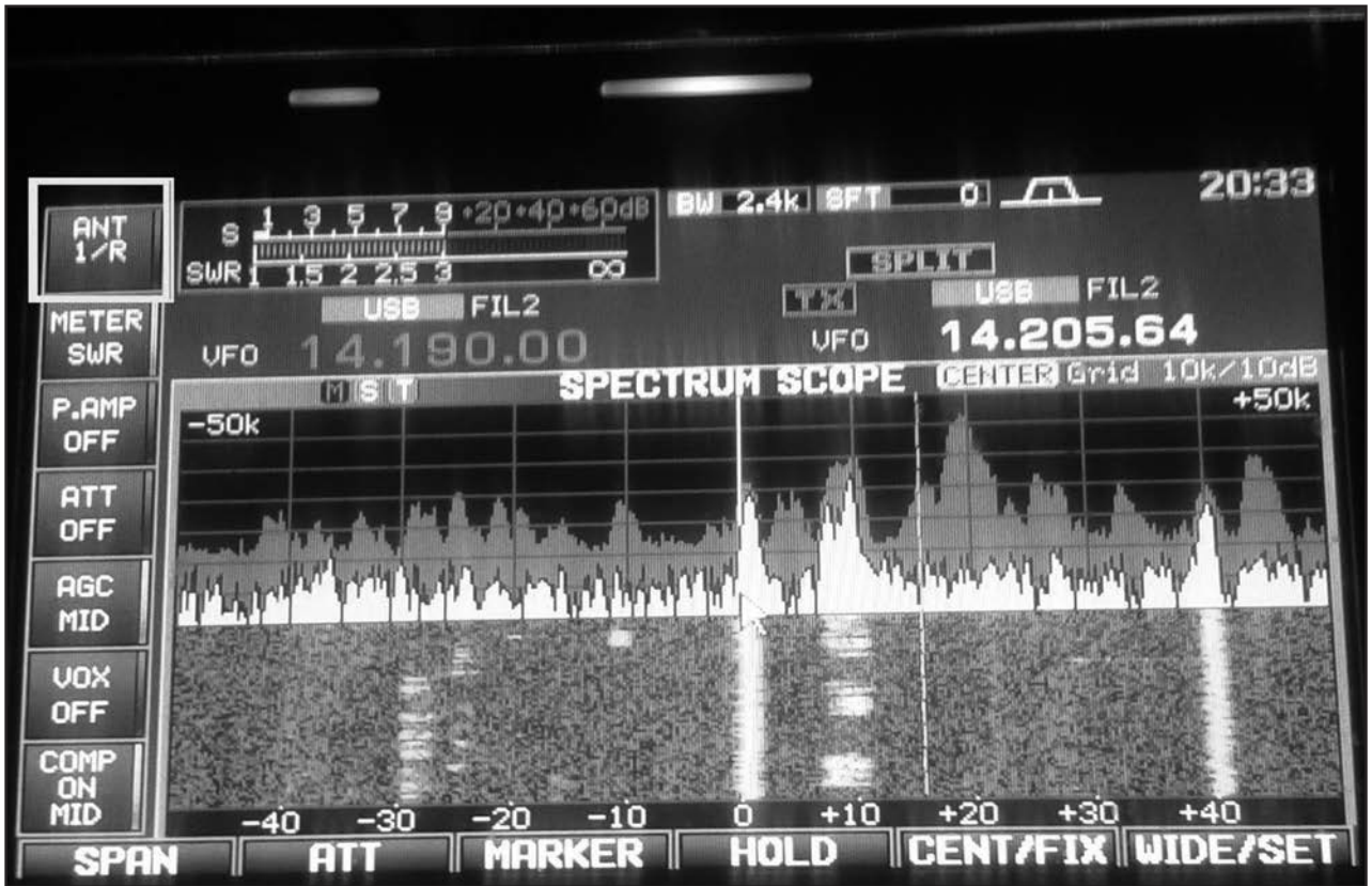
Imagen 7: Pantalla del Icom IC-7600 después de la ejecución de la Macro SDR para trabajar la estación en Split. VFO A fijo en la frecuencia del DX, VFO B activo en TX y sintonía, Split activado y posición de ANT1/R.
