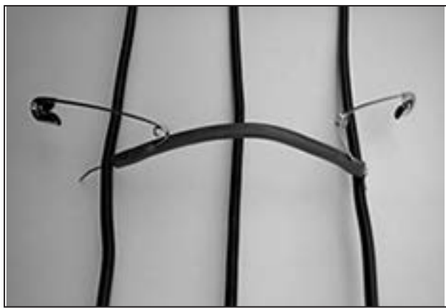
Figura 5: Conexión provisoria del puente.
