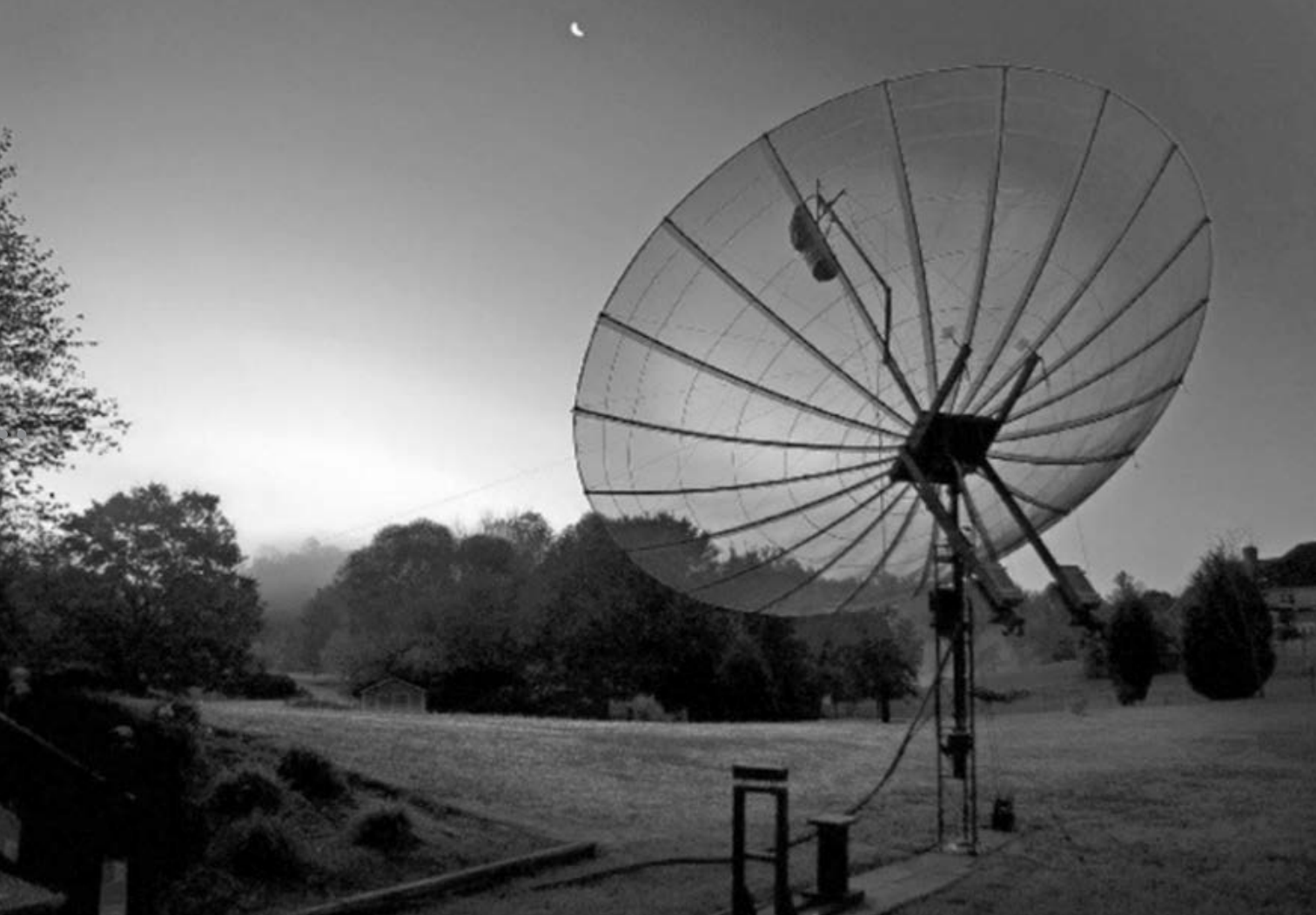
Figura 2. La antena parabólica de 6 metros de diámetro usada por N2UO para comunicación Tierra-Luna-Tierra. La abertura de recepción de esta antena es cercana al área de su boca circular (Foto Mark Franco, N2UO)
