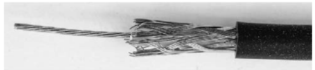
Foto 5: RG-174 desvainado con un pelacable de doble hoja.
