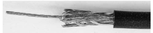
Foto 6: Corte de 2,5 mm de la malla.
