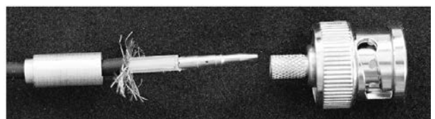
Foto 12: Terminación del BNC con el casquillo de crimpado en su sitio.
