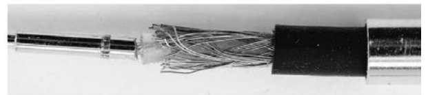
Foto 7: Pin central soldado en su sitio.
