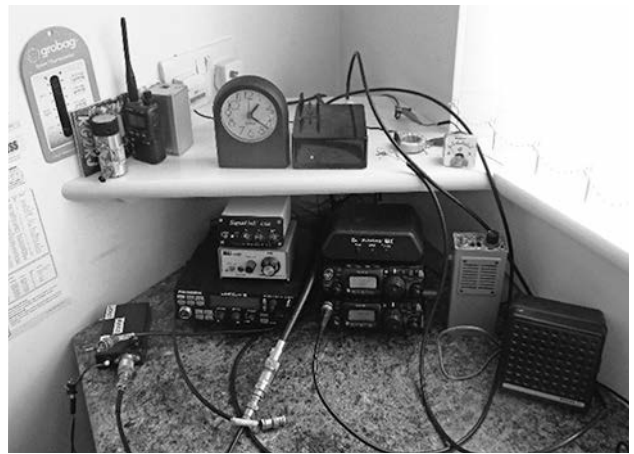
Figura 4: El shack. En el estante superior, de der. a izq., un medidor de corriente de antena, un sintonizador de antena de transformador toroidal, el transverter y un reloj. En el escritorio abajo, radios FT-817 y una interfaz de audio USB Signalink.
