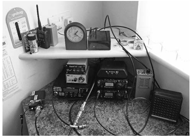
Figura 4: El shack. En el estante superior, de der. a izq., un medidor de corriente de antena, una sintonizador de antena de transformador toroidal, el transverter y un reloj. En el escritorio abajo, radios FT-817 y una interfaz de audio USB Signalink.
