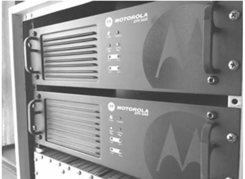
Figura 3: Dos repetidoras DMR Motorola.
