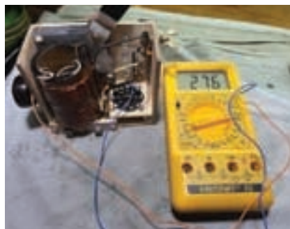
Foto 3: Midiendo el capacitor variable.
