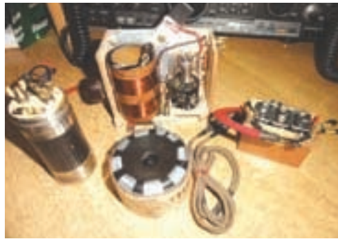
Foto 5: Vista del capacitor y la bobina de acoplamiento ensamblados
