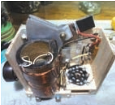
Foto 5: Vista del capacitor y la bobina de acoplamiento ensamblados
