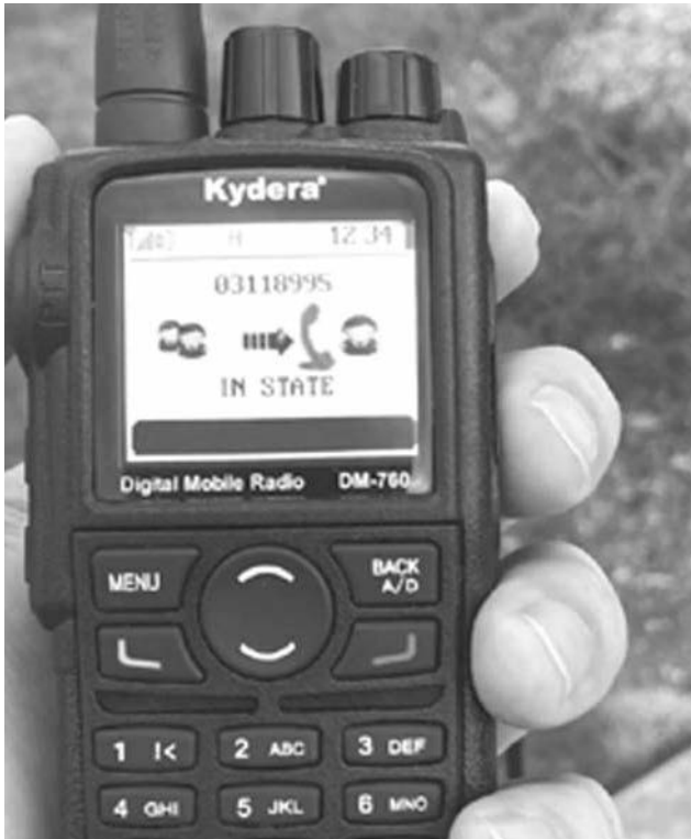
Figura 1: Un transceptor portátil DMR puede tener pantalla color, monocromática o ninguna.
