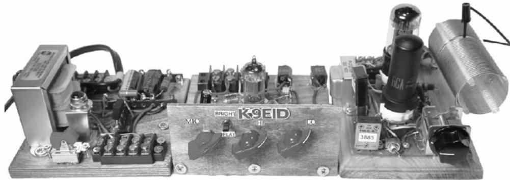
Figura 2). La primera etapa es un preamplificador de alta ganancia que alimenta la segunda etapa de la 12AX7, proporcionando suficiente salida para controlar el modulador Heising basado en la 6V6 del transmisor.
