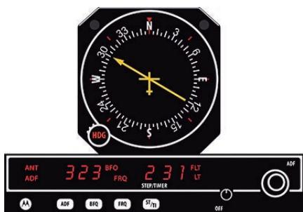
El sistema ADF también puede utilizar como radiofaro las emisoras de radiodifusión en onda media AM que emiten entre 530 y 1710 kHz.
