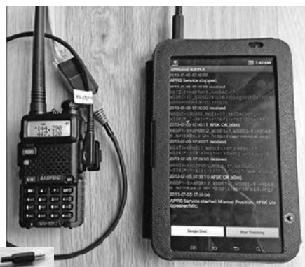
Fig. 1 El Baofeng UV-5R y la Samsung Galaxy Tab Wi-Fi conectados por cable con el APRSdroid en acción
