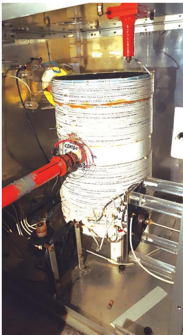
Variómetro de LF con toma de derivaciones a la derecha, sintonía remota al centro, balun adaptador con ventilador abajo y medidor de corriente de RF en amarillo.
