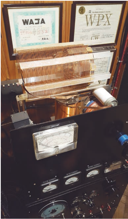
Vista del amplificador de RF valvular, inicialmente para LF y luego convertido para MF.
