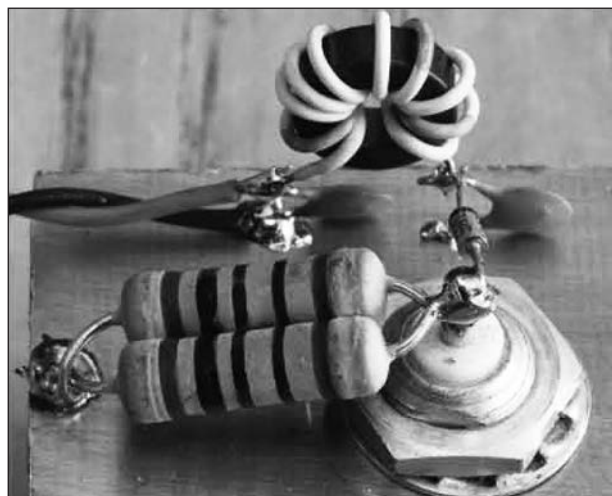
Foto 1: Medidor simple de 4 W de pico, que trabaja de LF a VHF.
